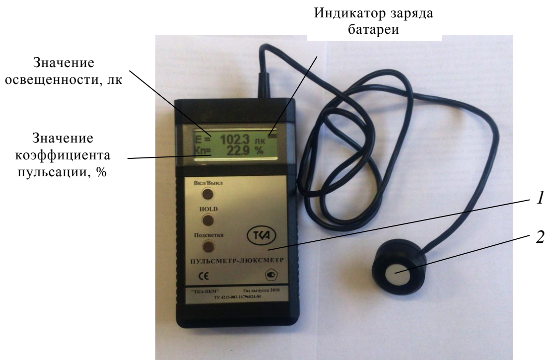
Рис. 2.4. Общий вид люксметра-пульсметра ТКА-ПКМ (08): 1 – блок управления и индикации; 2 – фотоэлемент.
